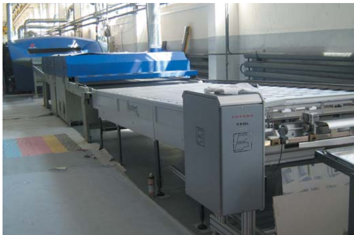
Широкоформатный принтер с сушкой в типографии PrintDesign, на первом плане — устройство обрезки
